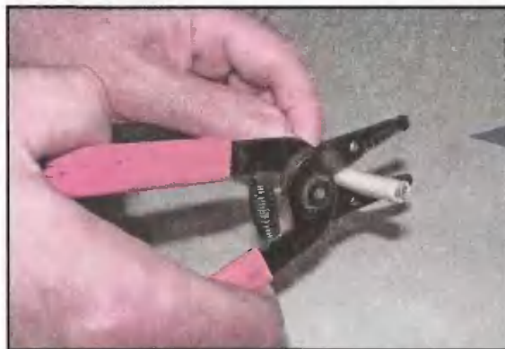
Этим инструментом можно отрезать кабель, надрезать изоляцию как внешнюю, так и на отдельных жилах и снять ее, не повредив проводники
