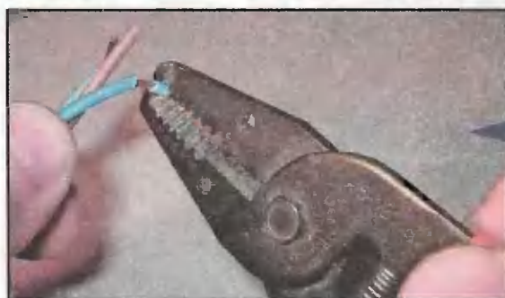
В зависимости от диаметра провода, надрезаю изоляцию отдельно каждой жилы. Снимать изоляцию с провода можно, используя зажим с закругленными краями носовой части инструмента
