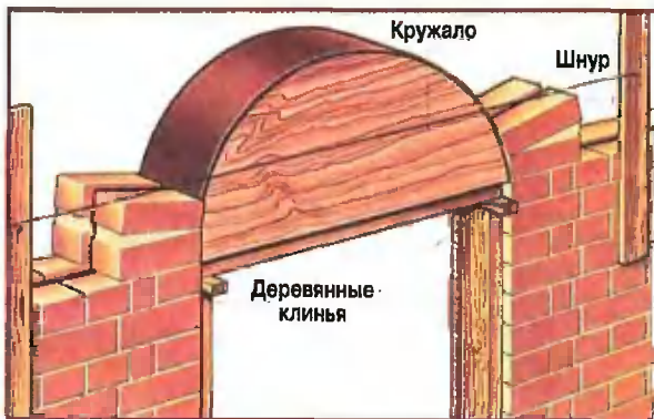
Рис. 1. Кружало — это не только шаблон для возведения арки, но и опора для укладываемых на него кирпичей. Между досками прикрепленными к стене досками натягивают шнур, позволяющий корректировать положение кирпичей, укладываемых в направлении к замку
